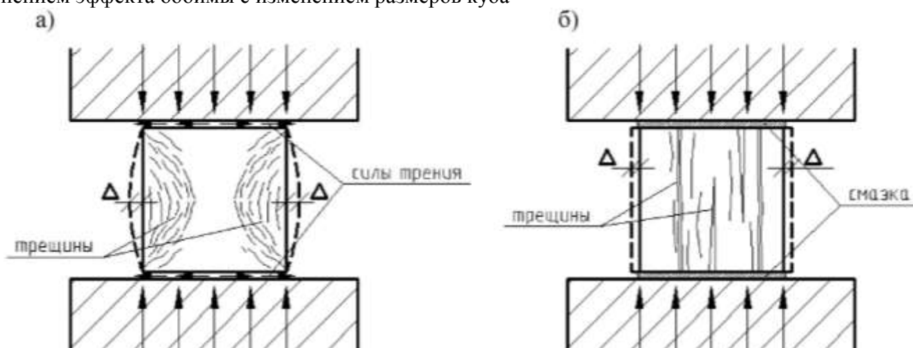
а – несмазанный куб; б – смазанный куб, \Delta – поперечные деформации бетона
